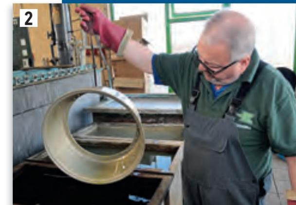
**2** EINE ALUMINIUM-CHROMATIERUNG bildet die haftfähige Basis für den neuen Lack- und Beschichtungsaufbau. Zudem dient sie als Korrosionsschutz
