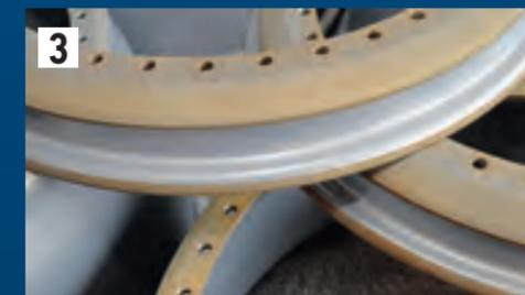
**3** VOR DEM LACKIEREN sind sämtliche Sitz- und Dichtflächen peinlichst genau abzudecken. Hier darf keinerlei Farbauftrag erfolgen
